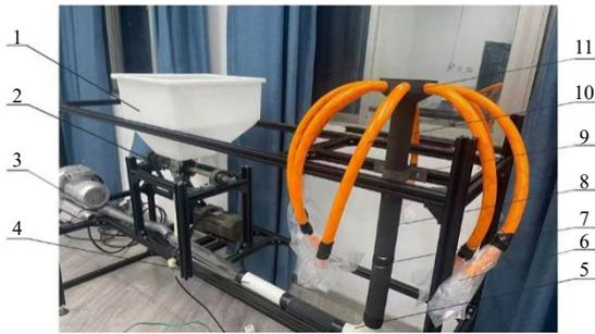
1 种箱; 2 供种装置; 3 风泵; 4 横向输种管; 5 弯管; 6 收集袋; 7 扩散环; 8 纵向输种管; 9 倾斜装置; 10 排种管; 11 分配器。
