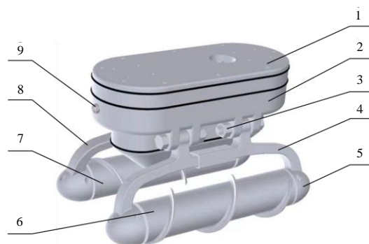
1 搭载平台; 2 控制箱; 3 花键插销; 4 左滚筒架; 5 支架圆头; 6 左螺旋滚筒; 7 右螺旋滚筒; 8 右滚筒架; 9 视觉模块。
