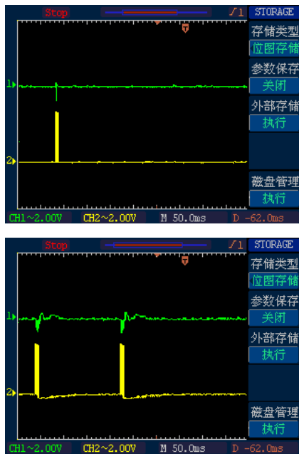
a 油菜种子下落信号与 TTL 信号; b 振动干扰信号与 TTL 信号。 图 7 调理电路采集的油菜种子下落与振动干扰信号
