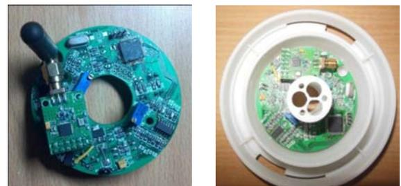
图 4 功能电路板及其在捕虫器壳体内部的安装
