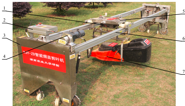
1 横向往复电机；2 控制系统；3 边架；4 纵向行走电机；5 往复机构；6 横梁；7 剪叶器。
