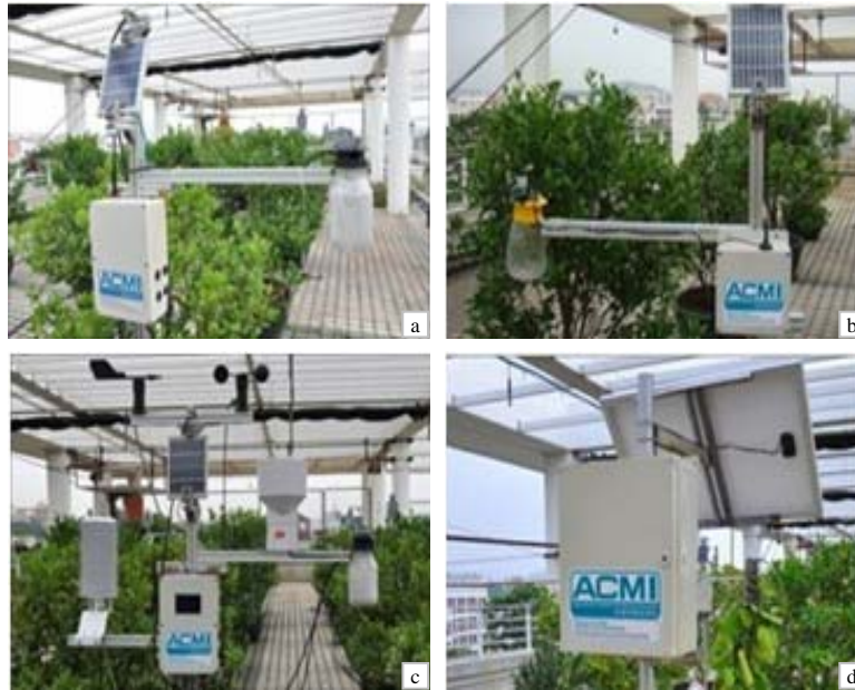
a 成虫监测节点(红外感应式); b 成虫监测节点(视觉); c 环境气象监测节点; d WSN 汇聚节点。
