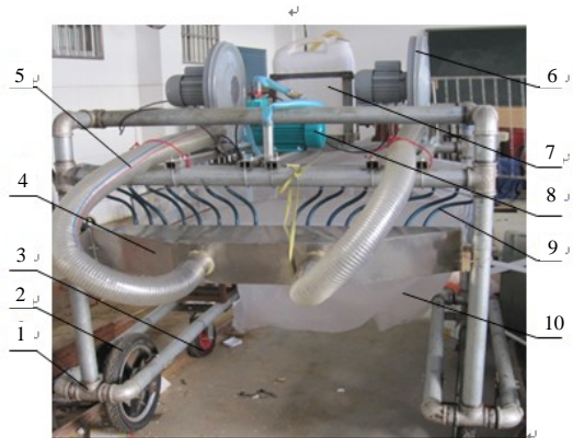
1 机架;2 主动轮;3 万向轮;4 出风装置;5 风管;6 鼓风机;7 水箱;8 水泵;9 水管;10 捕虫袋。
